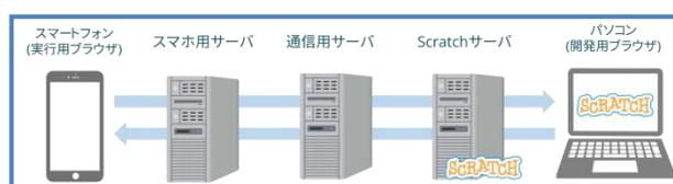
図1 ロボットプログラミングシステムの構成図
