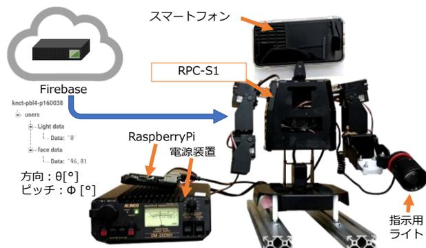
図3 製作したテレプレゼンスロボット
