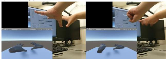
図3 Leap Motion による手のトラッキング例
