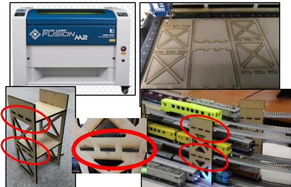
図 4 レーザ加工機及び完成した高架橋
