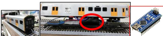
図 6 模型車両に組み込んだマイクロコンピュータ
