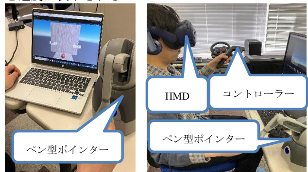
(a) ペン型ポインターを装着 (b) ペン型ポインターと HMD を装着
