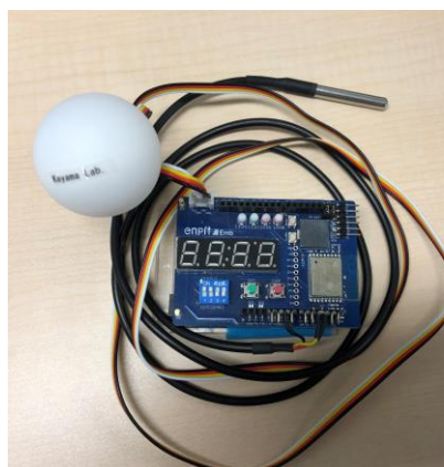
図 1 温度・照度計測用 IoT 教材
