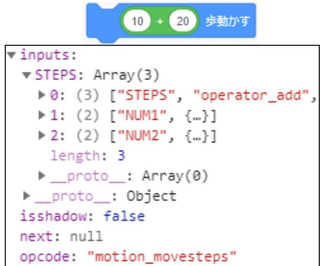
図4 整理したブロックのデータと対応するブロック
