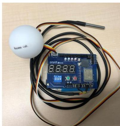
図1 温度・照度計測用IoT教材
