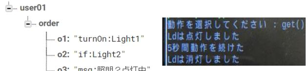
図5 Firebaseの管理画面および状態表示の状況
