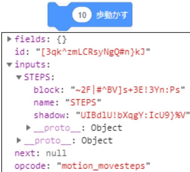
図2 ブロックのデータの例と対応するブロック
