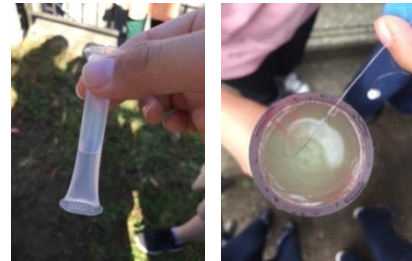
図2 簡易水質調査と透視度計による調査
