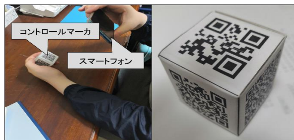
図 1 提案システムの外観とコントロールマーカ
