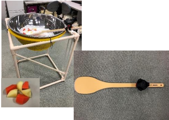
図2 模擬回転釜と模擬具材、スパテラと VIVE tracker
