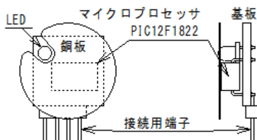
図1 従来のタッチセンサー しかしながら、従来手作りで作成していたため、
