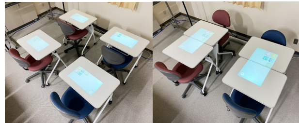
図 2 1つのプロジェクタによる UI の投影例 (左：受講者別、右：2名グループ別)
