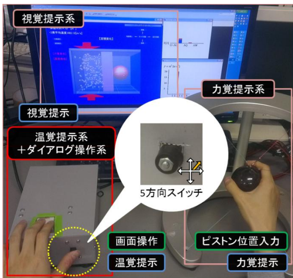
図2 一体型温覚提示装置(左下)
