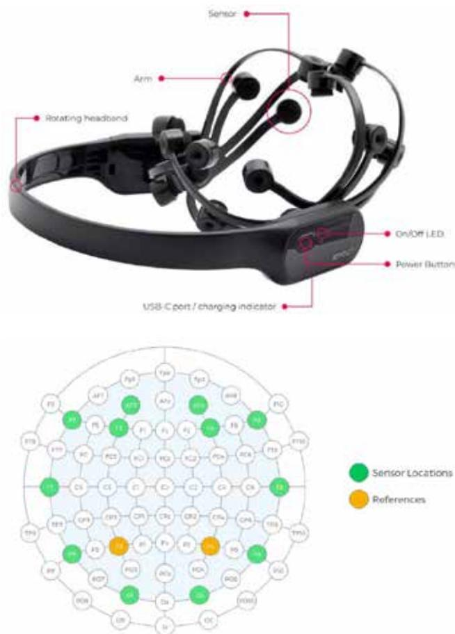
図1 EPOC X 14チャンネルの本体(上)<sup>(6)</sup>と脳波センサ位置(下)<sup>(6)</sup>
