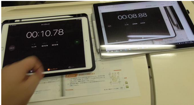
図 4 配信遅延時間の計測例
