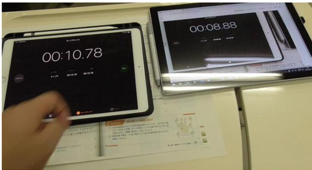
図 4 配信遅延時間の計測例
