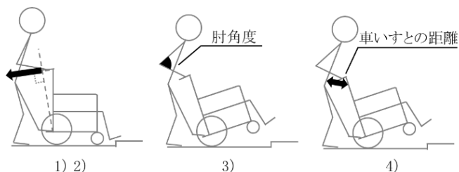
図8 車いす段差乗り越え時の操作姿勢
