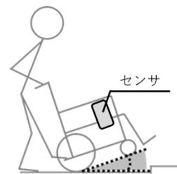
図1 車体の傾き角度
