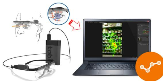
図 3 視線計測機器 Tobii Pro Glasses2
