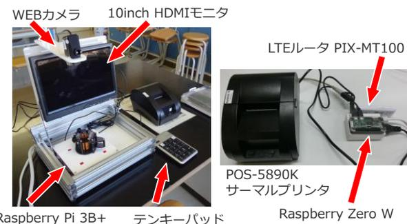
図 4. 作例データ収集システムと印刷サブシステム
