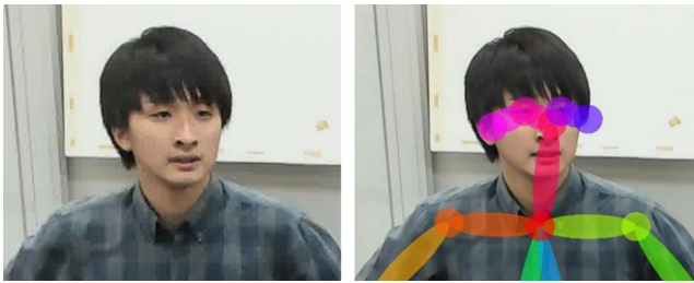
図5 対象人物の取得画像（左）と OpenPose による骨格検出結果（右）
