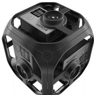
図 1 小型カメラを 6 台連結させた全天球パノラマ撮影システムの一例
