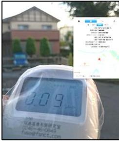
測定毎に、図1のように周辺の様子と測定終了の表示と測定値、測定器番号を写真に撮り、内部にGPSのジオタグを入れて撮影場所がわかるようにする。ファイル名は日付と測定回数にする。
