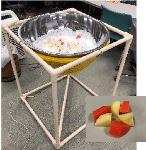
図2 模擬回転釜と模擬具材
