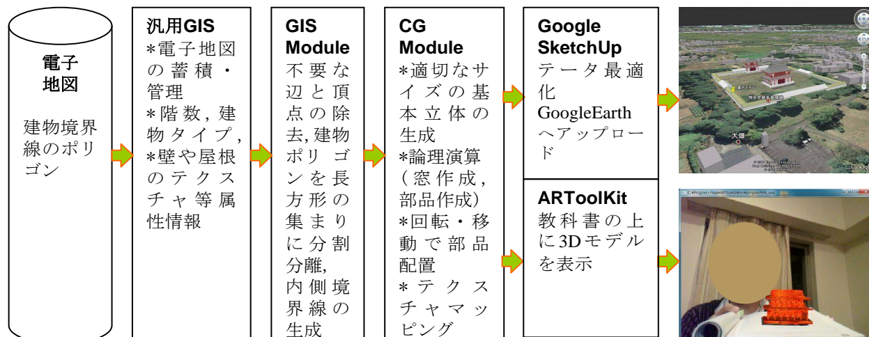
図 1 歴史教育支援システムの構成および古代の建築物の 3D モデルの自動生成処理の流れ
