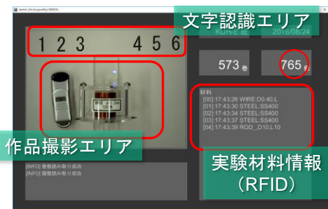
図7. RFIDと文字認識による試作型学習過程記録システム
