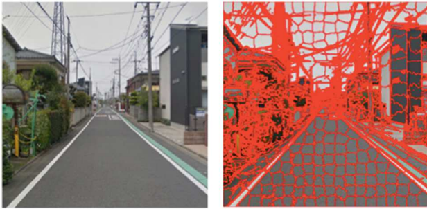
図 2 SLIC による領域分割例 元画像 (左)、SLIC による処理結果 (右)
