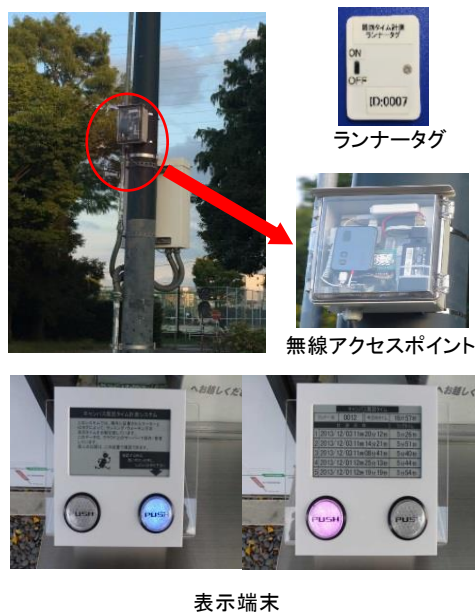
図 2 ラン&ウォーク自動記録システムの各機器
